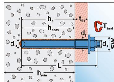
**Charges recommandées pour cartouches de scellement chimique PROFIX PVA pour béton non fissuré C25/30.**
