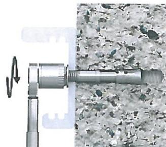
Bis zum empfohlenen Anzugsdrehmoment festziehen
