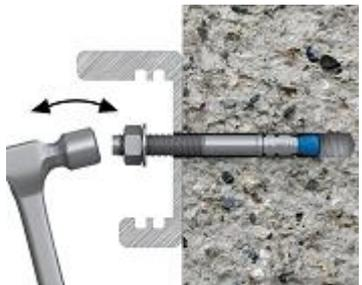
Den Keilanker mit einem Hammer leicht durch die Befestigung in das Loch anbringen, bis die Befestigungstiefe erreicht wird
