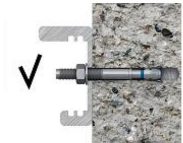
Montierter Zustand des Ankers
