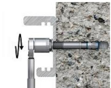
Bis zum empfohlenen Anzugsdrehmoment festziehen
